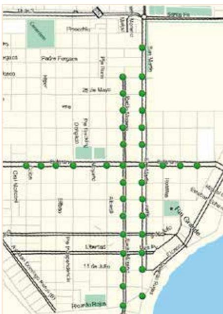
Los puestos de medición se implementan utilizando cámaras de video, que por medio del procesamiento digital de las imágenes, constituyen espiras virtuales que permiten recolectar los datos en tiempo real del estado de circulación de los vehículos. Su ubicación se ha planeado de forma tal de poder obtener todas las mediciones relevantes tanto del ingreso y egreso a la ciudad, como también en los puntos de alta afluencia de tránsito.
