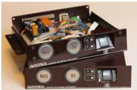
Las unidades de banca AUTOTROL [UB] se construyeron bajo normas ISO 9001-2001 y estándares internacionales para equipos electrónicos. El diseño de la misma se adecuó a la disponibilidad de espacio y de acuerdo a la sala de sesiones. Los microprocesadores que contienen la programación específica de la unidad controladora son de prestaciones industriales de marca estándar de una empresa líder a nivel mundial.
