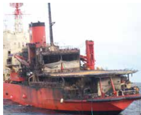
> Estado del Buque una vez apagado el incendio
